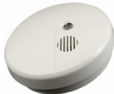
Branddetektor 500-IDx: (x=O, I, T, OT, Re) O: Optisk, I: jonisk, T: Termisk, Re: reläsockel OT: Multikriterie optisk/termisk D=118mm, H=36mm (H=42mm inkl sockel)
